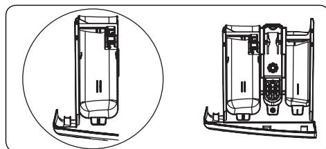
Это отделение предназначено для жидких или порошковых моющих средств или для средства для удаления известкового налета. Дозатор для жидкого моющего средства поставляется внутри машины. (\*)
