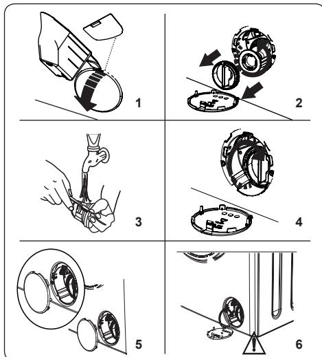
Установленный в стиральной машине фильтр насоса продлевает его срок службы, предотвращая попадание ворсинок в машину. Очистку фильтра насоса рекомендуется выполнять через каждые 2 месяца. Фильтр насоса находится под крышкой в правом нижнем углу лицевой стороны машины.
