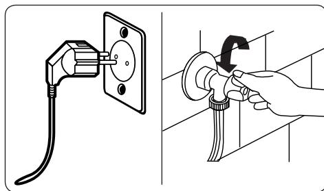
Перед началом очистки и технического обслуживания машины необходимо отключить источник питания и извлечь штепсельную вилку из розетки. Перед началом очистки и технического обслуживания машины необходимо закрыть кран подачи воды.
