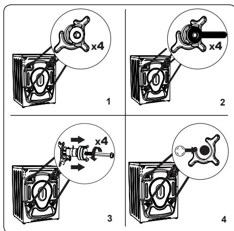
1. Перед началом эксплуатации стиральной машины демонтируйте четыре транспортировочных болта и резиновые прокладки, расположенные на ее тыльной стороне. Не извлеченные болты могут стать причиной сильной вибрации, шума, поломки машины и аннулирования гарантии.
