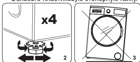
2. Вращайте ножки по часовой стрелке, чтобы поднять машину. Вращайте ножки против часовой стрелки, чтобы опустить машину.
