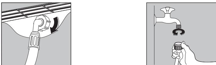
*Если на задней панели есть только один водозаборный клапан, подсоедините его к крану холодной воды. Если на панели два клапана, один подключается к крану холодной воды, а второй — к крану горячей воды. См. рисунок ниже.*
