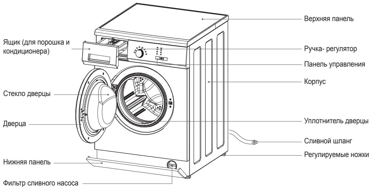
**Примечание:** Если машина не будет использоваться в течение длительного периода времени, выньте фильтр сливного насоса, чтобы слить воду.
