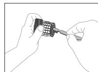
1. Выключите машину, отсоедините ее от сети питания. С помощью отвертки откройте крышку насоса.
