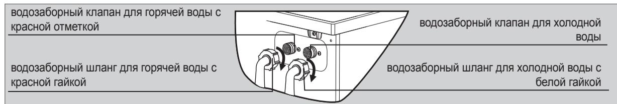
**Примечание:** Не все модели имеют клапан для подключения к крану горячей воды.
