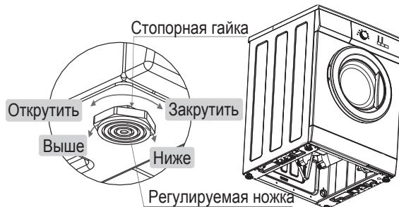
**Примечание:** Если стопорные гайки неплотно закручены, во время работы стиральной машины могут возникать вибрации и шумы.
