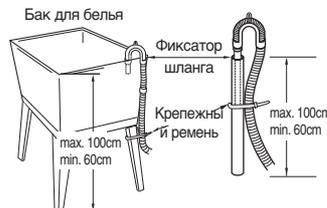
При установке сливного шланга к сточной трубе, прочно прикрепите его лентой.
