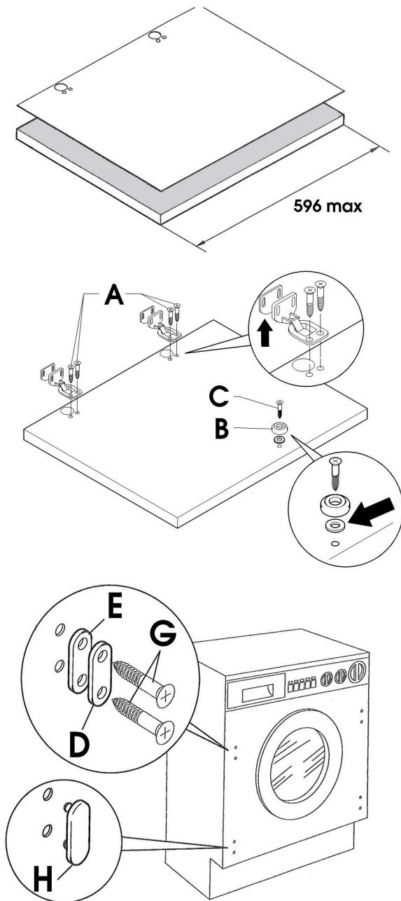
Закрепите дверцу с петлями с помощью винтов (L) на передней стороне стиральной машины.
