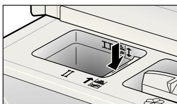
При использовании жидкого моющего средства (только в программе без предварительной стирки):
