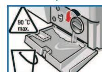
3. Осторожно отверните крышку насоса (остаточная вода!).
