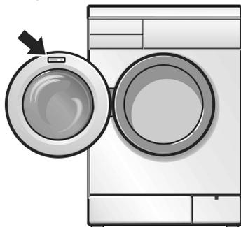
Эти данные Вы найдете в фирменной табличке, расположенной изнутри на раме дверцы загрузочного люка и, взятые в жирную рамку, на обратной стороне машины.
