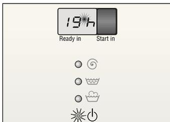
Отсчет времени задержки начинается сразу же после его установки. Это можно определить по мигающей точке между цифрой и "h". Точка мигает до тех пор, пока установленное время не истечет.
