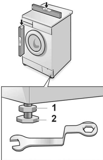
Все четыре ножки стиральной машины должны устойчиво стоять на полу. Машина ни в коем случае не должна качаться. Контргайки всех четырех ножек машины должны быть закручены так, чтобы они плотно прилегали к ее корпусу!
