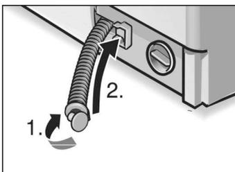
Снимите колпачок (1.) и вставьте сливной шланг в держатель (2.).
