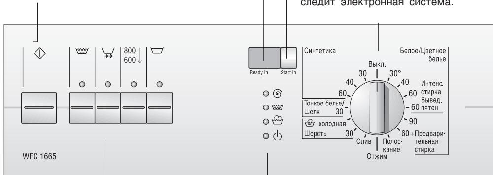
**Клавиши выбора дополнительных функций** (при желании функции можно активировать дополнительно к программе)
