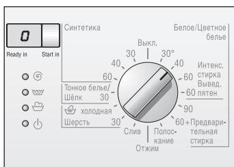
**i** В начале программы проводится подсчет времени для индикации "Ready in". При этом допускается, что в машину загружено максимально допустимое количество белья, и температура подаваемой в машину воды составляет 15 °С. Затем в течение первых 10 минут стирки определяется фактическое количество белья.
