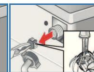
6. Подсоедините шланг и проверьте герметичность соединения.
