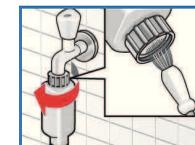
5. Очистите сетчатый фильтр: Отсоедините шланг от водопроводного крана. Прочистите фильтр с помощью щётки. **И/или** для моделей с многоступенчатой системой защиты от протечек и моделей с системой Aqua-Secure: отсоедините шланг от задней стенки машины, извлеките фильтр щипцами и очистите.
