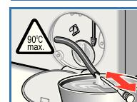
3. Снимите закрывающую пробку и слейте моющий раствор. Приготовьте соответствующую емкость.
