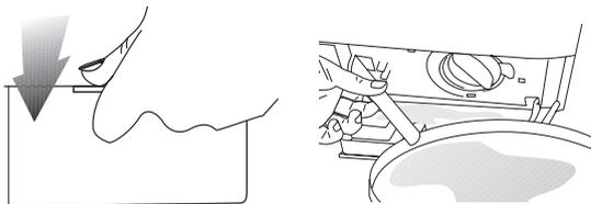
Перед открытием фильтра слейте воду через сливной шланг. Отсоедините сливной шланг. Подготовьте подходящий контейнер и откройте заглушку шланга. После того, как вода слита, установите заглушку на место. Откройте фильтр, поворачивая и сливая оставшуюся воду (max 30 мл) через заглушку фильтра. Очистите инородные объекты внутри фильтра. По завершении поворачивайте его по часовой стрелке и закройте. Закройте заглушку фильтра, надавив на нее.
