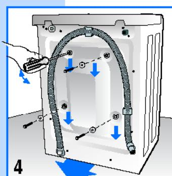
Для транспортировки прибора его качающейся узел блокирован 4 распорками с болтами. Прежде чем подключить машину, при помощи гаечного ключа следует вынуть транспортировочные болты.
