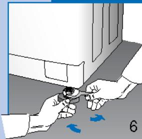
Выберите подходящее место и отрегулируйте машину по уровню при помощи регулируемых ножек (Рис. 6).
