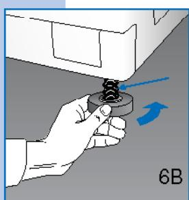
При наличии модели стиральной машины для установки под рабочим столом завинтите ножки, чтобы полностью сжатая пружина позволила установить ее под столешницей (Рис. 6B).
