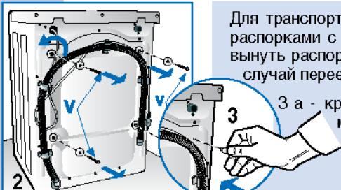
Для транспортировки прибора его качающийся узел блокирован 4 распорками с болтами. Прежде чем подключить машину, следует вынуть распорки и транспортировочные болты и сохранить их на случай переезда.
