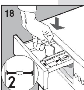
Не забудьте убрать емкость или перегородку жидкого моющего средства при использовании стирального порошка.
