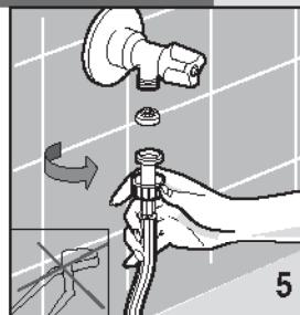
**Прим.** В электронных стиральных машинах, оборудованных двойным электроклапаном (горячей и холодной воды) соедините красную трубку с краном горячей воды, а другую трубку - с краном холодной. Если кран горячей воды использовать нельзя, обе трубы должны быть подсоединенены к крану холодной воды при помощи специального прилагаемого патрубка (смотри рис. 5А).
