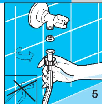
**Прим.** В электронных стиральных машинах, оборудованных двойным электроклапаном (горячей и холодной воды) соедините красную трубку с краном горячей воды, а другую трубку - с краном холодной. Если кран горячей воды использовать нельзя, обе трубы должны быть подсоединенены к крану холодной воды при помощи специального прилагаемого патрубка (смотри рис. 5A).
