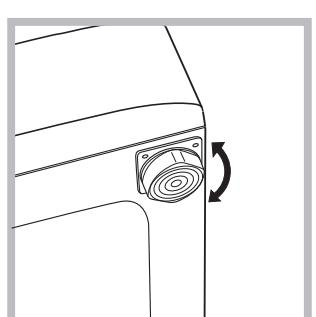
сначала ослабьте контргайку, после завершения регулировки контргайку затяните.
