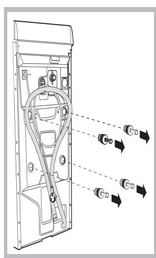
3. Удалите четыре транспортировочных винта и резиновые пробки с прокладками, расположенные в задней части стиральной машины (см. рис.).
