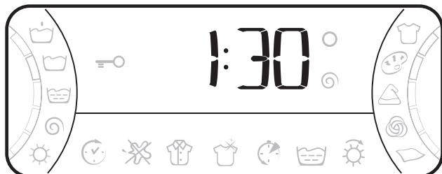
При нажатии кнопки ПУСК/СБРОС (Start/Reset) для запуска программы на дисплее показывается приблизительное время, остающееся до завершения цикла. В случае установки отложенного старта программы (пуск по таймеру, см. с. 19) дисплей будет показывать время, оставшееся до начала стирки.
