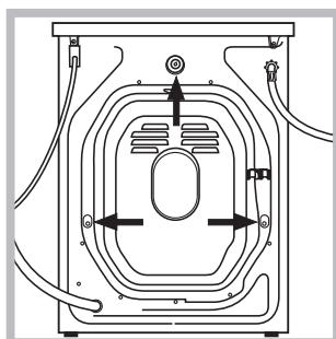
3. Снимите 3 винта, предохраняющие машину в процессе перевозки, и резиновые пробки с соответствующими распорными шайбами, расположенные в задней части стиральной машины (см. рис.).
