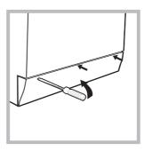
3. снимите переднюю панель стиральной машины при помощи отвертки *(см. схему)*.
