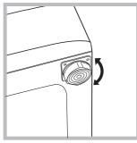
2. Если пол не является идеально горизонтальным, необходимо компенсировать неровность, отрегулировав по высоте передние ножки (см. схему). Уклон, измеренный при помощи уровня, установленного на поверхность машины, не должен превышать 2°.
