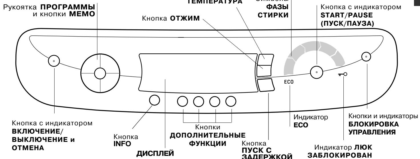
**Кнопка с индикатором ВКЛЮЧЕНИЕ ВЫКЛЮЧЕНИЕ и ОТМЕНА:** нажмите кнопку для включения или выключения машины. Зеленый индикатор показывает, что машина включена. Для отключения стиральной машины в процессе стирки необходимо держать нажатой кнопку, примерно 2 секунды. Короткое или случайное нажатие не приведет к отключению машины. В случае отключения машины в процессе стирки текущий цикл отменяется.
