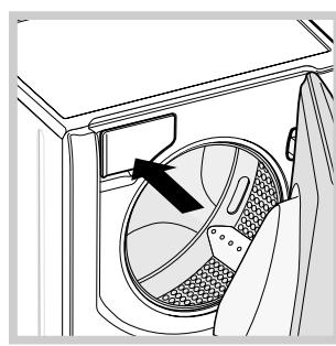
Дозатор находится внутри машины и доступен через люк.
