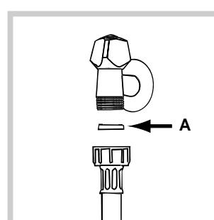
2. Вставьте прокладку А из пакета в конец водопроводного шланга и привинтите его к водопроводному крану холодной воды с резьбовым отверстием 3/4 gas (см. рисунок).
