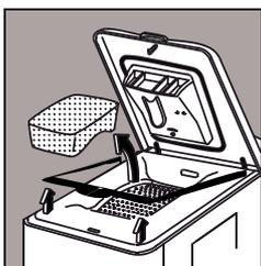
Откройте крышку стиральной машины и выньте приспособления, предотвращающие вращение барабана, и пластиковую прокладку. Закройте крышку.
