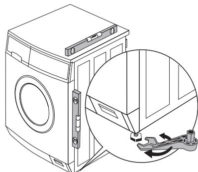
**Внимание!** Никогда не пытайтесь компенсировать мелкие неровности пола с помощью деревянных, картонных или подобных прокладок - только путем регулировки ножек.
