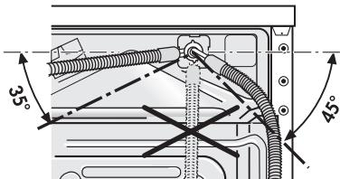
2. Подсоедините шланг его прямым концом к водопроводному крану с винтовой нарезкой R 3/4 дюйма.
