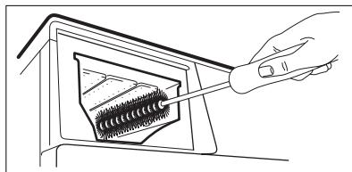
5. Очистите нишу дозатора с помощью щетки.
