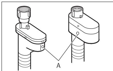
Наливной шланг оснащен устройством для защиты от протечек воды. Это устройство предотвращает протечки, которые могут иметь место по причине естественного старения шланга. О возникновении такой неисправности предупреждает появление красного сектора в окне "A".
